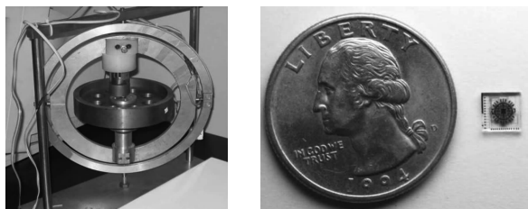
图 1-8 传统陀螺仪与 MEMS 陀螺仪
