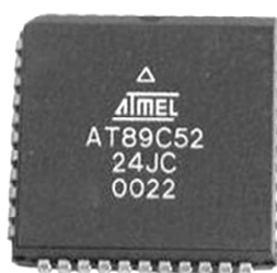
(f)PLCC 封装 AT89C52(44 引脚)
