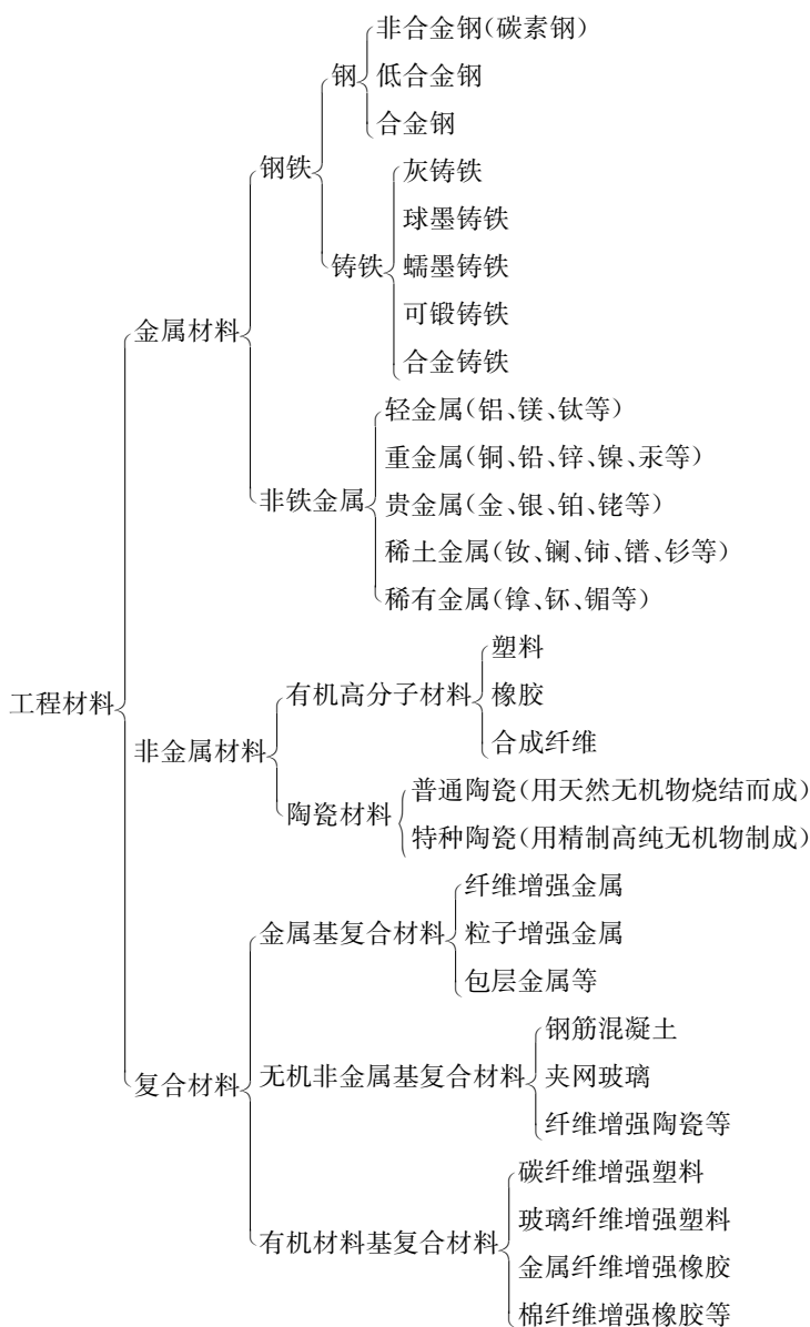
图 1.1 工程材料按成分分类图
